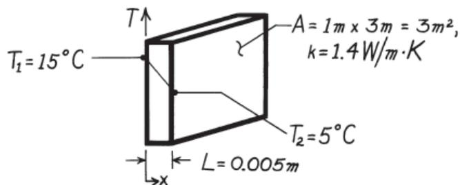
Qual será a taxa de transferência de calor que o equipamento de resfriamento deverá garantir para o resfriamento desta área da parede?
