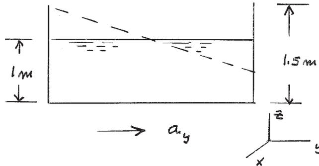
A aceleração lateral ( $a_y$ ) máxima a que este tanque pode se submeter sem que haja transbordamento é:
