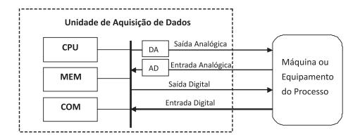
Considere que o conversor Digital-analógico da UAD seja de 12 bits e possua uma saída de fundo de escala de 10V. O valor da tensão da Saída Analógica para uma sequência Digital enviada pela CPU igual a **010110101011** será de
