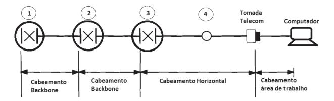
A figura acima representa a **Estrutura do Cabeamento Genérico** de acordo com a norma NBR 14.565/2007. Os números referem-se aos elementos funcionais deste sistema. Uma identificação CORRETA para estes números é:
